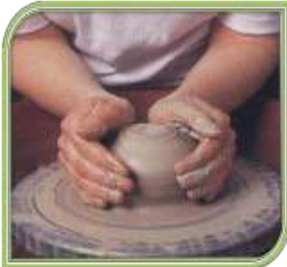
Tahap pemusatan tanah liat plastis di atas putaran dengan cara menekan tanah liat. Penekanan dilakukan dengan menggunakan kedua tangan, tangan yang satu menekan dari atas dan tangan lain menahan pada bagian samping. Lakukan proses ini dengan benar
