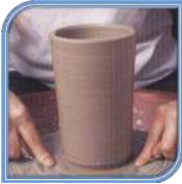
Setelah selesai pisahkan dasar silinder dengan alas pembentukan menggunakan kawat pemotong, angkat benda kerja dengan alas pembentukannya dan keringkan.
