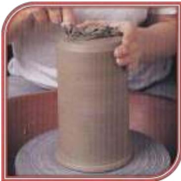
Setelah benda cukup kering untuk trimming atau turning, lakukan finishing pada bagian dasar benda keramik, buatlah kaki sesuai dengan gambar kerja.
