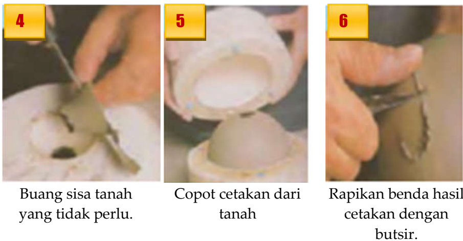
Gambar 1.12 Proses pembuatan gerabah dengan cetak basah dengan teknik cor
