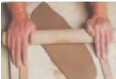
Gambar 1.7 Membuat lempengan dengan rol
