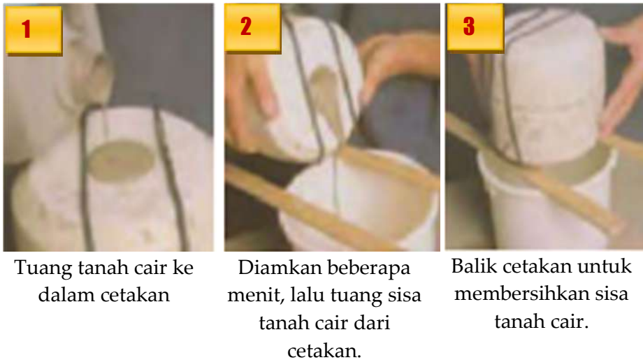
Gambar 1.11 Proses pembuatan gerabah dengan cetak basah dengan teknik cor
